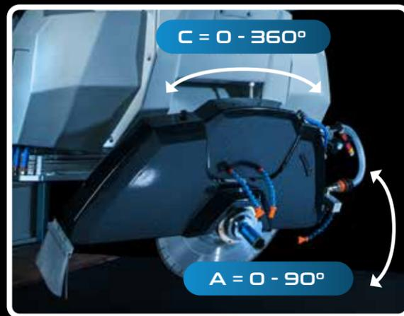
Interpolated auto head inclination for perfect miter and tilted cuts. Inclinazione automatica della testa interpolata per tagli obliqui e inclinati perfetti.
